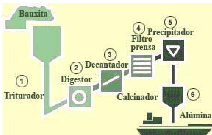
Figura 2 . Esquema simplificado de la producción de alúmina
