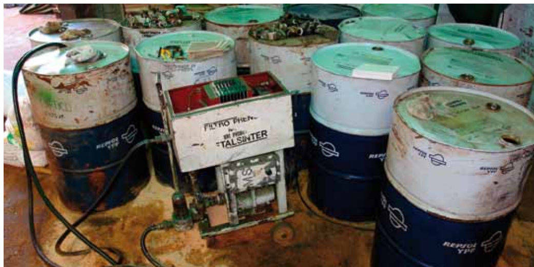
Equipo de filtración de aceite usado, posiblemente contaminado
