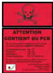
Etiqueta de Moldavia para equipos que contienen PCB
