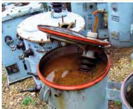
Equipos eléctricos donde se observa que el aceite es una mezcla con agua
