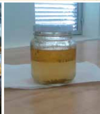
Equipos eléctricos donde se observa que el aceite es una mezcla con agua
