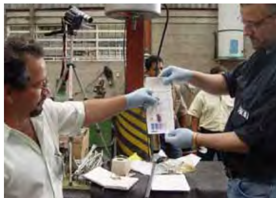
Resultado del análisis de un aceite con el kit CLOR-N-OIL
