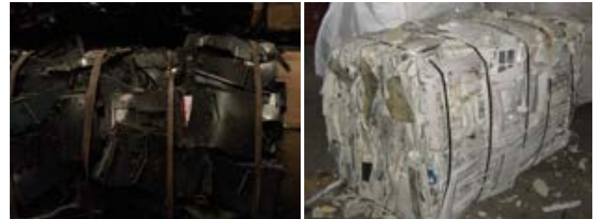
Figura 36. Plástico ABS con una fracción proveniente de Monitores y TV CRT, contaminado con C-OctaBDE, en etapa de empaclado para su exportación.
