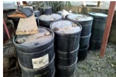
Figura 43. Concentrados de espumas contra incendios donadas que se encuentran vencidas y algunas obsoletas en la Estación de Bomberos Voluntarios en Puerto Barrios, Izabal
