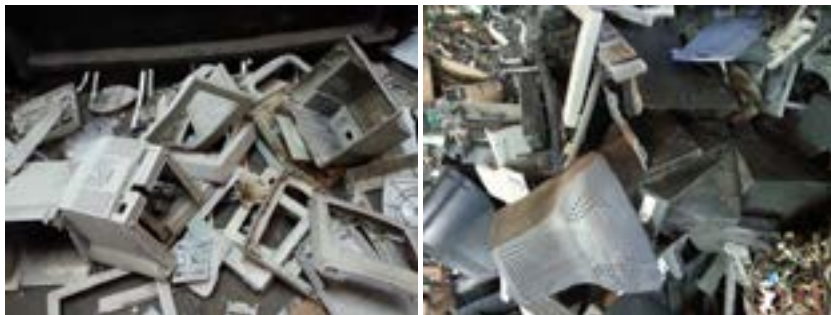
Figura 35. Plástico ABS con una fracción proveniente de Monitores y TV CRT, contaminado con C-OctaBDE, en etapa intermedia de su proceso para ser reciclado.
