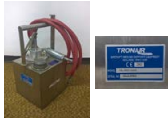
Figura 47. Dispositivo cerrado para bombear sólo fluidos de ésteres fosfatados usado por talleres privados. Inserto placa con modelo y número de serie
