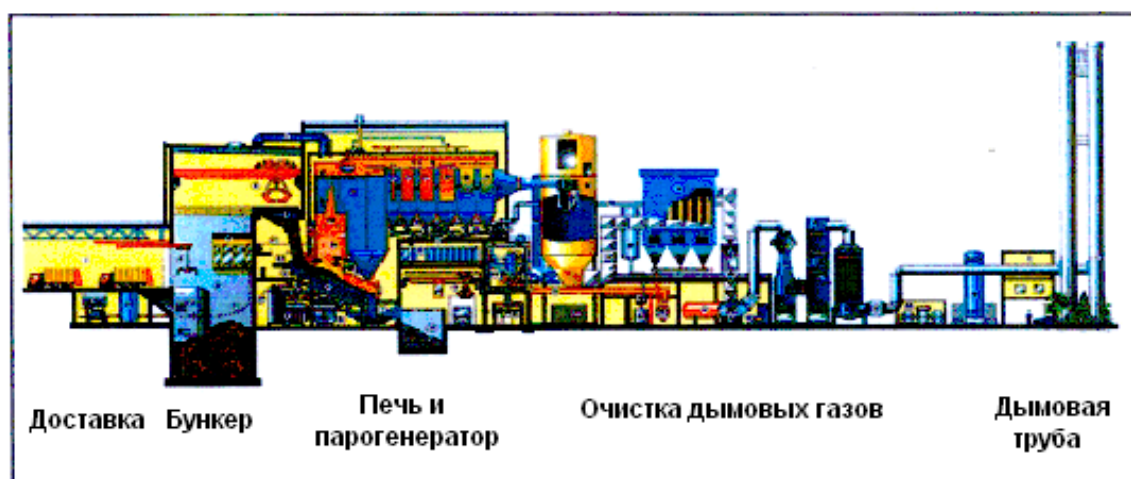
Рис. 2. Типичная установка для сжигания твердых бытовых отходов
